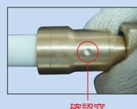
確認窓より管が見えること、管を手で引張り継手から抜けないこと、再度確認窓より管が見えることを確認します。その後養生テープで、継手に保温材を取り付けてください。
